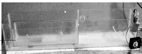
شکل ۱- حمام اسید و حمام آب ساخته شده به همراه نخ پیچ نصب شده در انتهای حمام انعقاد.
