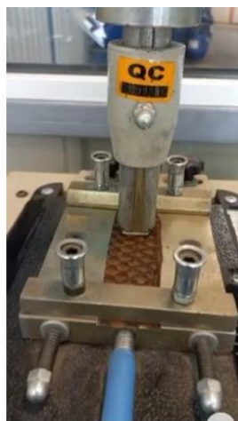
شکل ۳. مراحل انجام آزمایش تست مالشی مرطوب چرم ماهی تیلایا
