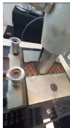
شکل ۴. تست مالشی خشک چرم ماهی تیلاپیا
