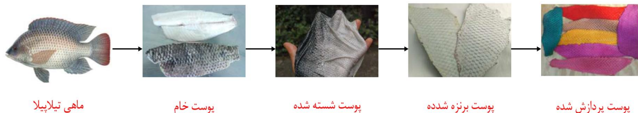
شکل ۲. مراحل تبدیل پوست ماهی به چرم [۱۷]
