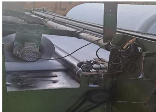
شکل ۷- محل نصب انکدر بر روی دستگاه برش
