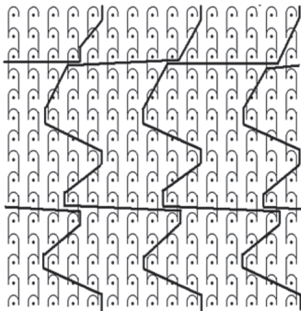
شکل ۴- ساختار حلقوی تری این‌لی قابل بافت با دو میله راهنما [۲۴].
