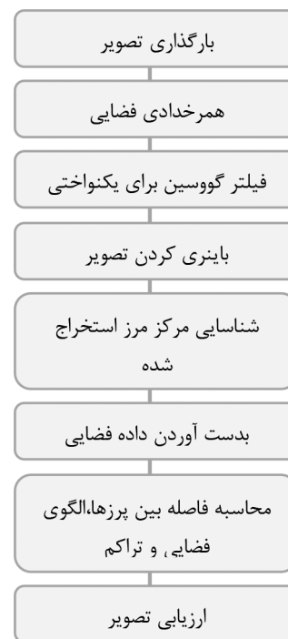
شکل (۲۷): نمودار جریان اندازه گیری تناوب و موقعیت پرز [۳۴]
