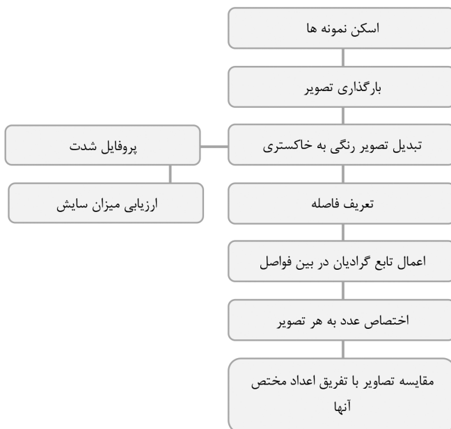
شکل (۴۲): نمودار جریان بررسی مقاومت سایشی کفپوش با پردازش تصویر برگرفته از [۴۶]
