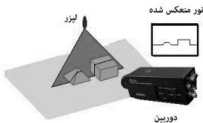
شکل (۳۸): روش نوری برای اندازه گیری عمق در اشکال سه بعدی بر پایه مثلث بندی [۴۳]
