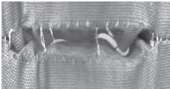
گسیختگی ناشی از پارگی نخ دوخت
