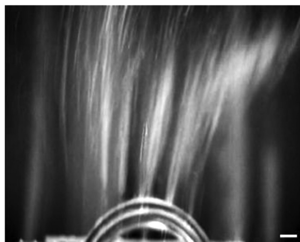
شکل ۲۲- (الف) طرح کلی دستگاه الکترورسی حلقه‌ای ماریبیچ، (ب) بزرگ‌نمایی تصویر حلقه و تصاویری از فرایند الکترورسی حلقه‌ای ماریبیچ (ج) تصویر جلو و (د) تصویر کناری [۱۶].
