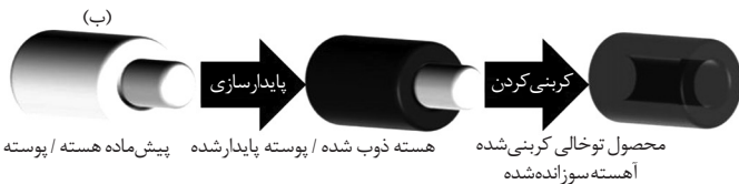
شکل ۳۳- (الف) نیم‌رخ عمل‌آوری گرمایی و (ب) تحول ساختاری در طول عمل‌آوری گرمایی [۵۵].
