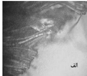
شکل ۵- تصویر بزرگنمایی شده از الف: لبه پارچه در برش با کاتر. ب: لبه پارچه در برش لیزری.
