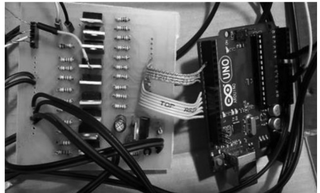
شکل ۶- اتصال برد مدار چاپی به برد آردوینو توسط فلت رابط
