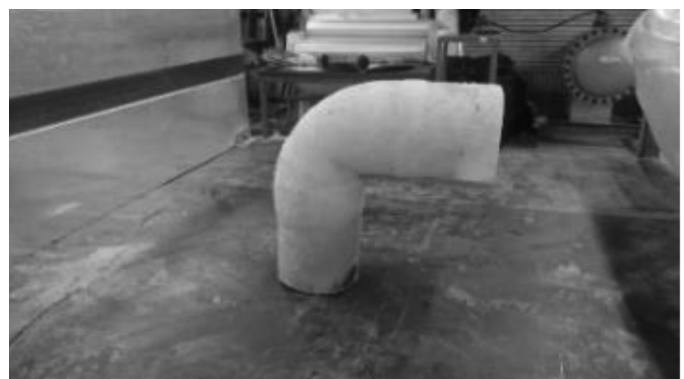
شکل ۵- زانویی کامپوزیتی تولیدشده با استفاده از پیش شکل شیشه و روش بلا در مولدینگ
