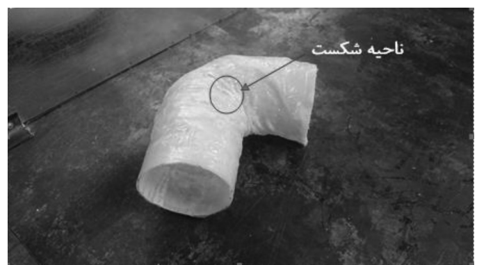
شکل ۹- نمونه کامپوزیت غیر یکپارچه پس از شکست
