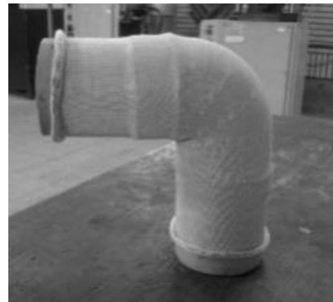
شکل ۱- نمونه‌ی پیش‌شکل بافته شده با نخ شیشه
