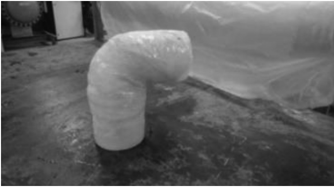
شکل ۶- زانویی کامپوزیتی تولیدشده با استفاده از پیش شکل غیریکپارچه
