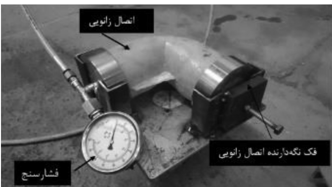
شکل ۷- آزمایش فشار هیدرواستاتیک نمونه کامپوزیتی یکپارچه
