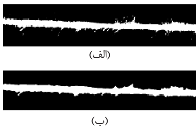
شکل ۷- تصویر: (الف) نخ پس از حذف بالک‌های اضافی و (ب) استفاده از فیلتر میانگین پس از حذف بالک‌های اضافی [۱۸].
