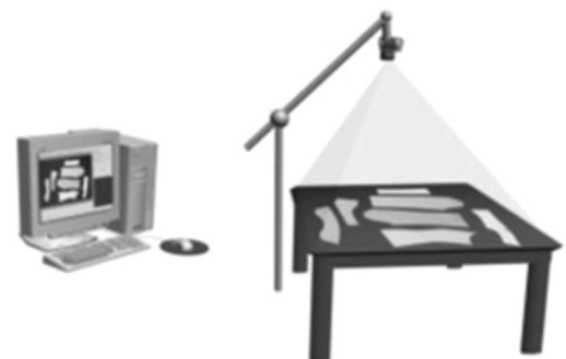
شکل ۴- روش دیجیتالی کردن الگو توسط دوربین [۱۰].
