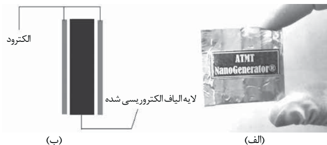
شکل ۵- (الف) نمایی از نمونه الکتروود گذاری شده با ابعاد ۲×۲ cm و (ب) نمای کلی از نحوه قرار گیری الکتروودها و لایه الیاف الکترورسی شده.
