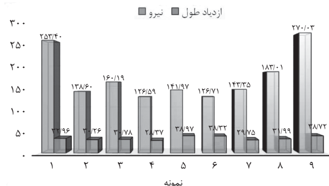
شکل ۸- اثر جابه‌جایی موقعیت پل تار بر ازدیاد طول نسبی (%) و استحکام کششی نخ‌های تار در ۹ نمونه تولید شده (N).
