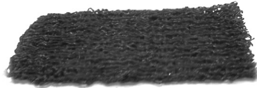
شکل ۳- وضعیت پارچه پس از گذشت ۵۰ s در دمای ۷۳°C.
