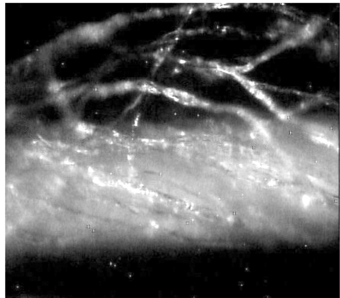
شکل ۲- نخ مغزی‌دار تولید شده در کشش ۳۰ برابر برای نیمچه‌نخ.
