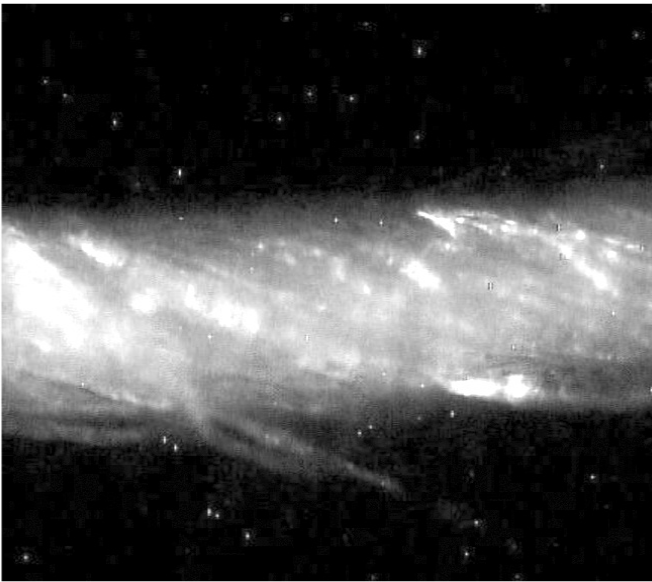
شکل ۳- نخ فاقد مغزی تولید شده در کشش ۳۰ برابر برای نیمچه‌نخ.
