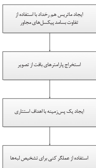
شکل ۲۱- نمودار جریان تشخیص استتار به روش ماتریس هم‌رخداد و روش کنی [۳۵].
