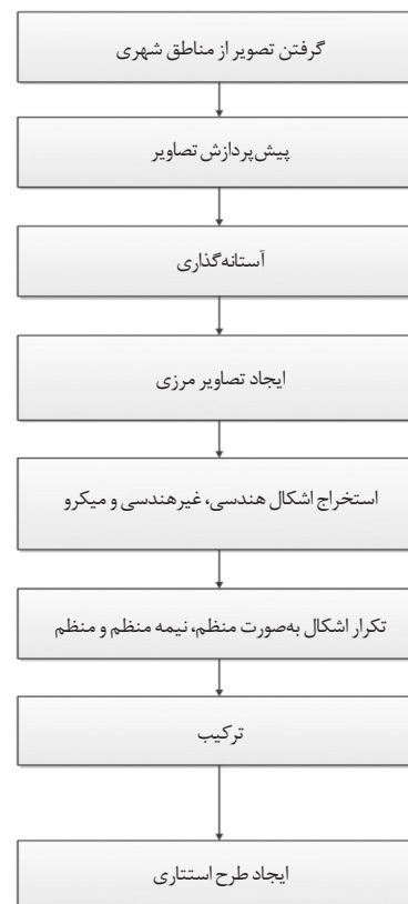
شکل ۶- نمودار جریان تولید طرح استتاری با استخراج شکل‌ها [۱].
