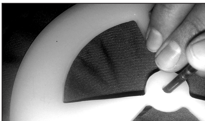
شکل ۵- تغییر شکل پارچه در اثر فشار میله مدرج
