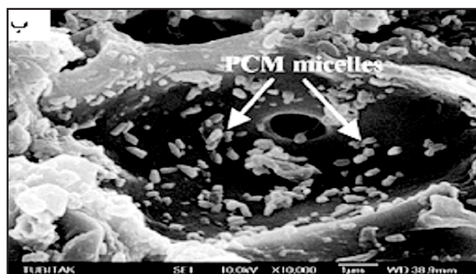
شکل ۴- پلی یورتان حاوی n-هگزادکان: (الف) بزرگنمایی ۱۰۰۰X، (ب) بزرگنمایی ۱۰۰۰۰X [۳]
