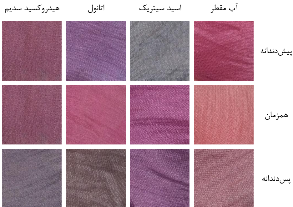
شکل ۴: نتایج بصری نمونه‌های ابریشم رنگ شده به روش‌های مختلف در محیط‌های مختلف استخراج رنگدانه
