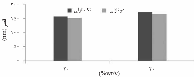
شکل ۸- تغییرات قطر نمونه‌های تک‌نازلی و دو نازلی.
