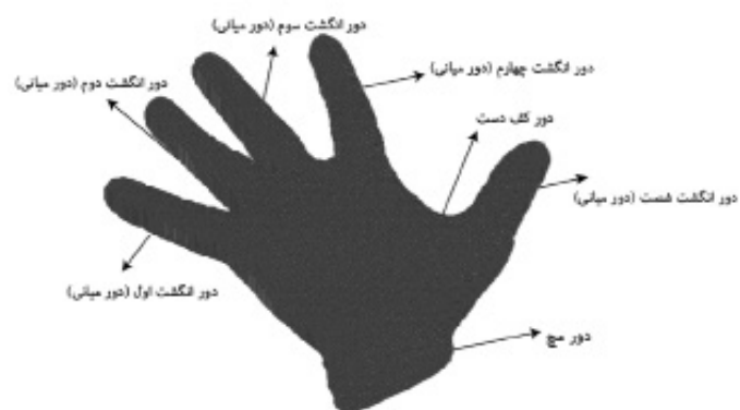
شکل ۱۱: اندازه‌گیری دور میچ، دور کف دست و دور انگشتان در مدل سه بعدی دست
