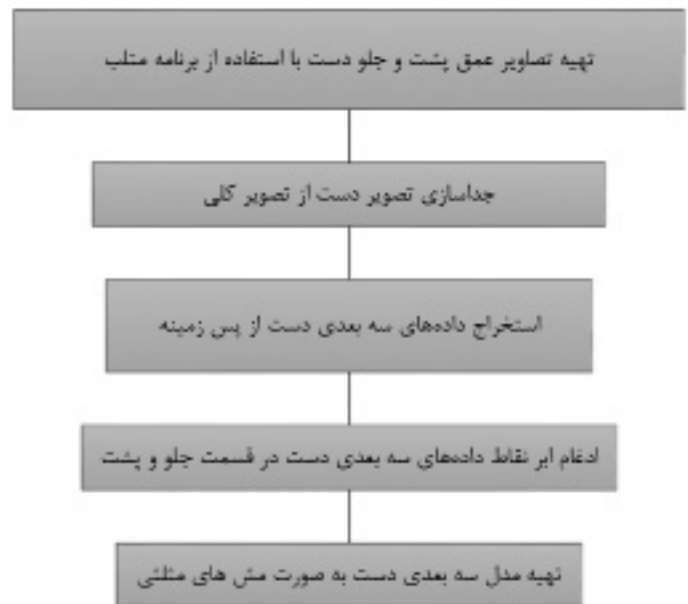
شکل ۲- فلوچارت روش استخراج مدل سه بعدی دست
