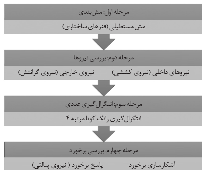
شکل ۳- مراحل شبیه‌سازی رفتار آویزش پارچه.
